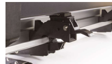
Pression des galets ajustable pour (CE7000-130/160)
